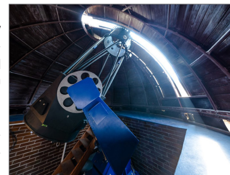
Obr. 4.3: 70cm ďalekohľad AGO pre sledovanie kozmického odpadu
