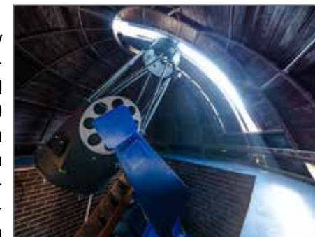
Obr. 4.3: 70cm ďalekohľad AGO pre sledovanie kozmického odpadu
