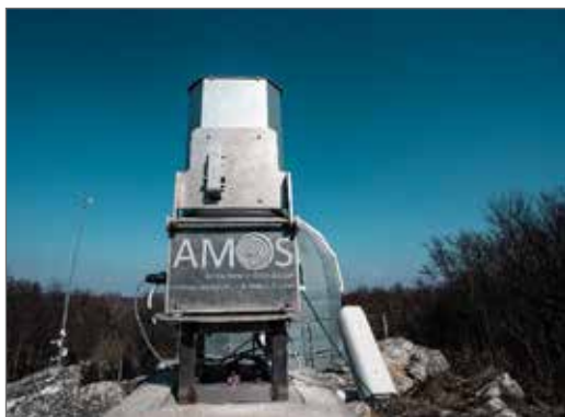
Obr. 4.4: Automatická stanica systému AMOS inštalovaná na AGO
