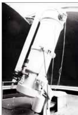
Obr. 2.2: Dalekohled observatoře Masarykovy univerzity o průměru 60 cm s fotonásobičem v Newtonově ohnisku
