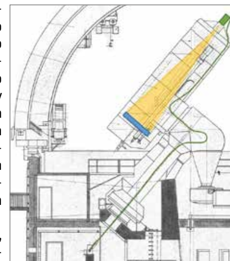
Obrázek 1.1: Schéma dalekohledu spolu s nazončenou cestou světla optickým vláknem k přístrojům.
